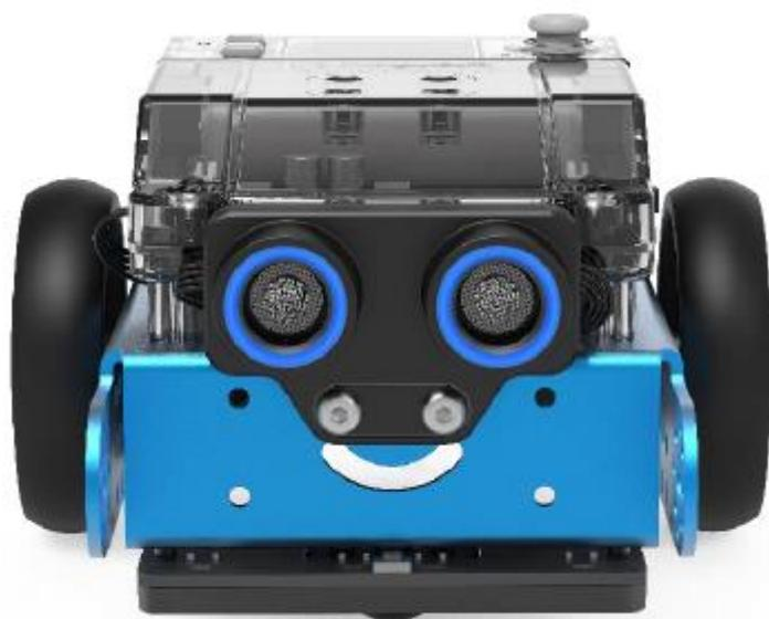
Abbildung 3: Ultraschallsensor
