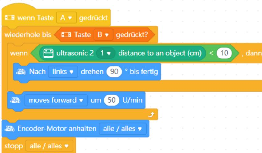
Abbildung 39: Ultraschallsensor (Entfernungsmessung)
